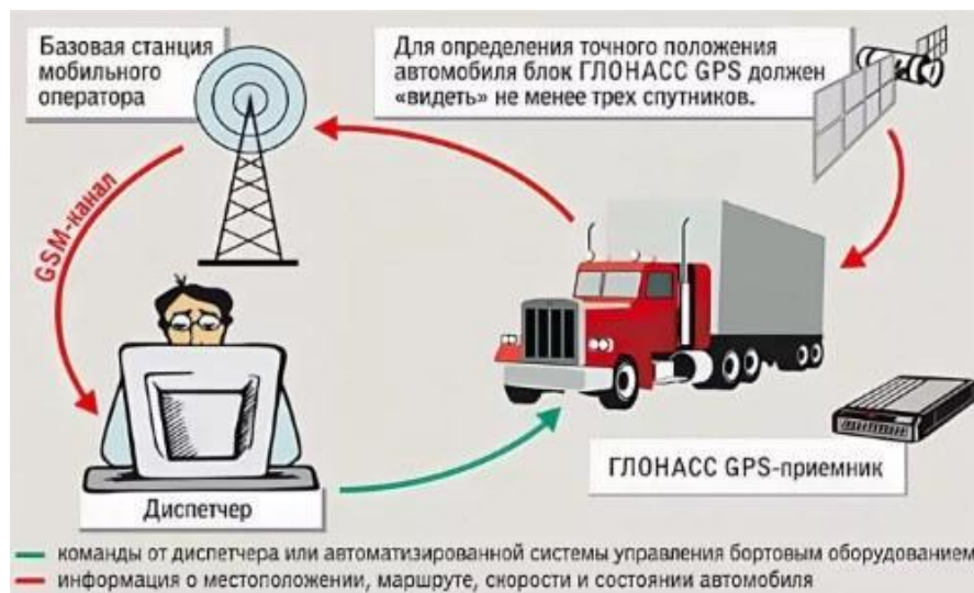
Рисунок 2.3 - Взаимодействие системы мониторинга и диспетчера
